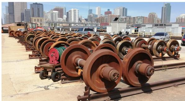
図 3 車両検修工場内の輪軸
