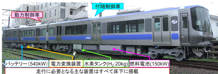
図 2 鉄道総研の試験車両の外観と機器配置
