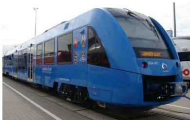
図4 世界初の試験営業運転を行った燃料電池鉄道車両 ALSTOM iLint
