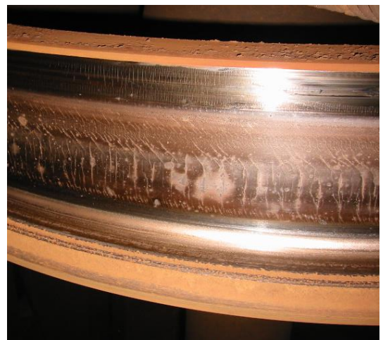
実車の踏面熱き裂の例
