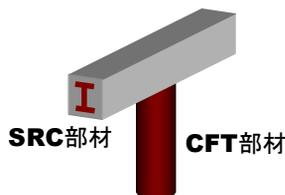
(b)異種部材の接合部を有する構造物
