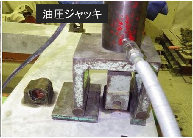
埋込材の引抜試験
