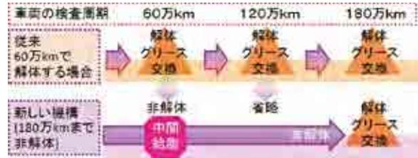
図3-1-22 入替給脂機構を用いた主電動機検修のイメージ
