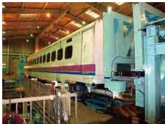
図4-3-1 車体間運動模擬装置を導入した車両試験装置
