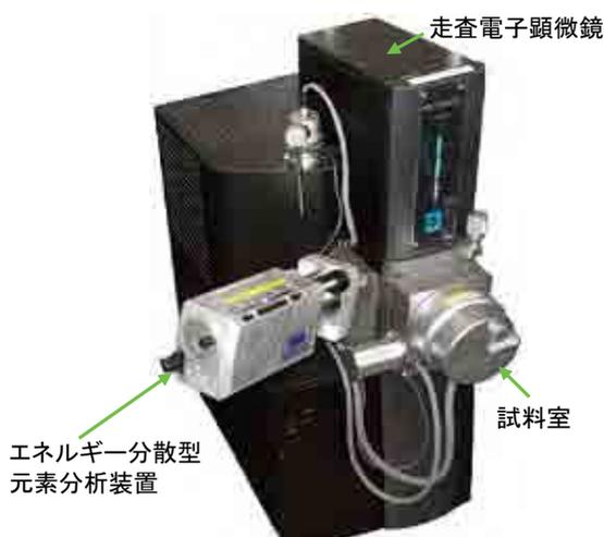
図4-3-3 エネルギー分散型元素分析機能付加低真空型走査電子顕微鏡
