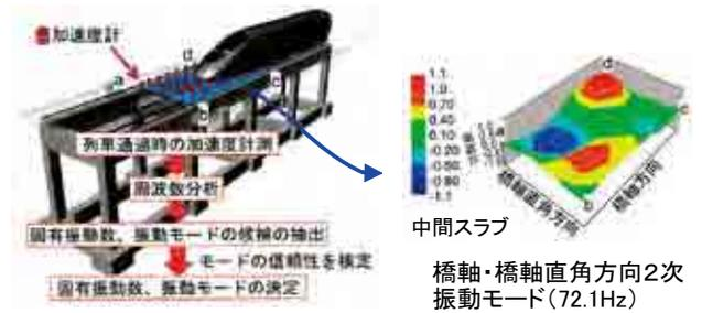
図3-1-24 部材振動特性推定手法と振動モード推定例
