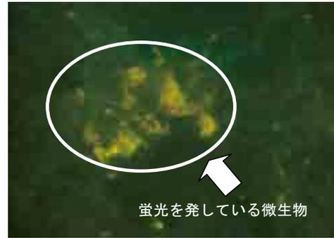
図3-1-26 トルエンを検知して蛍光を発している様子
