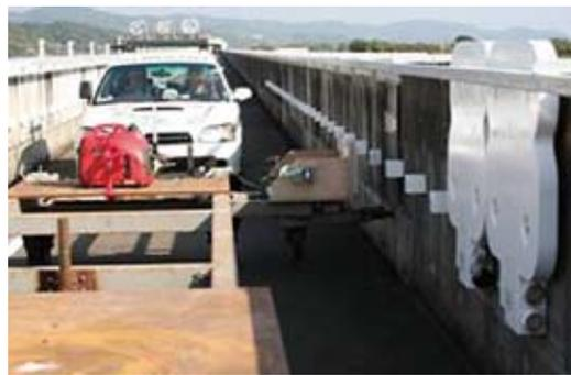
図3-1-28 車載アンテナによるタグ情報読取試験状況
