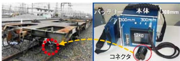
図3-1-6 貨車ブレーキ指令線の断線箇所検知装置
