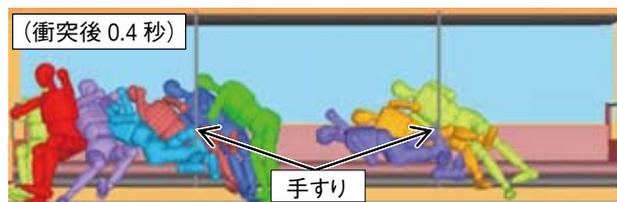
図3-1-26 ロングシートの乗客挙動シミュレーション
