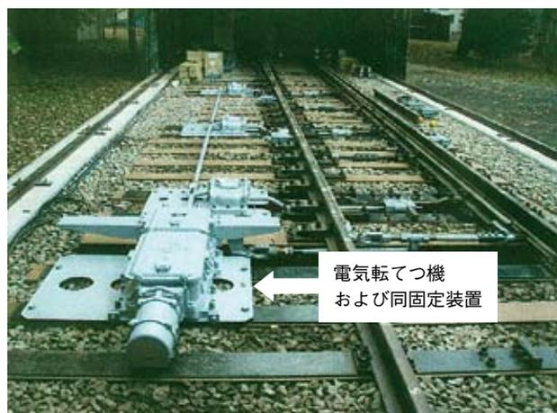
図4-3-3 転換試験用新幹線分岐器
