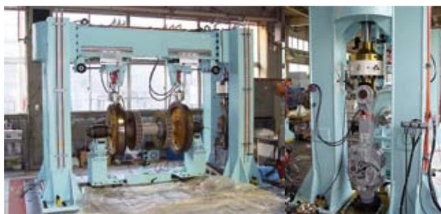
(a) 輪軸較正状況 (b) 連結器較正状況
