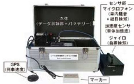
図3-1-13 波状摩耗モニタリング装置
