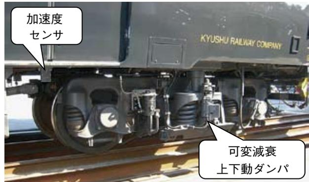
図3-1-5 まくらばね並列型可変減衰上下動ダンパ
