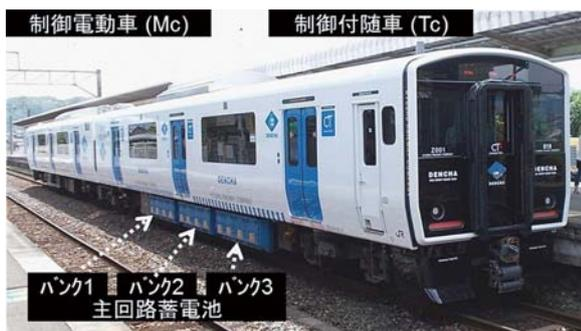
図4-2-1 JR九州BEC819系蓄電池電車
