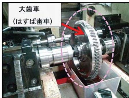
図4-2-2 高強度型球状黒鉛鋳鉄を用いた大歯車(1/3モデル)
