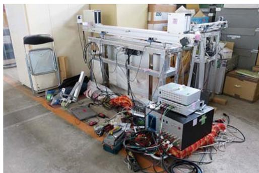
図5-5-2 電車線精密凹凸測定装置
