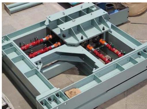
図5-5-3 地盤载荷試験装置
