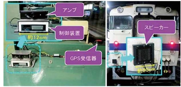
図4-11-2 改良した鹿忌避音発生装置
