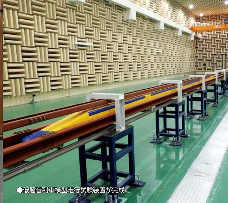
●低騒音列車模型走行試験装置が完成
