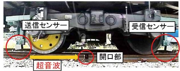
図4-5-2 非接触空中超音波センサーを搭載した試験車両
