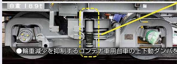
●輪重減少を抑制するコンテナ車用台車の上下動ダンパを開発
