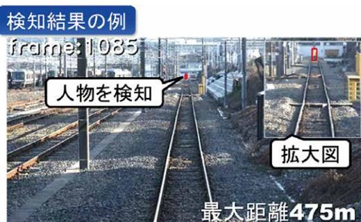
図4-7-1 列車前方監視手法の検知実験例
