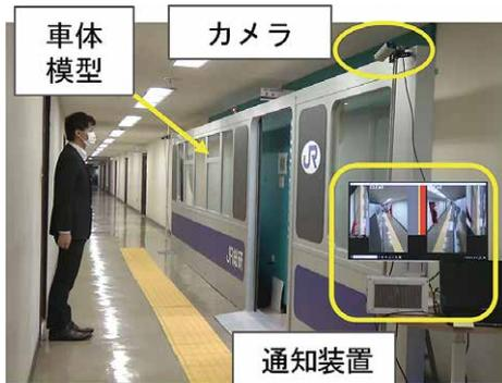
図3-1-4 車両側面カメラを用いた安全確認手法の概要
