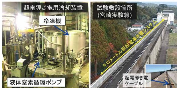
図3-1-5 超電導き電ケーブルシステム
