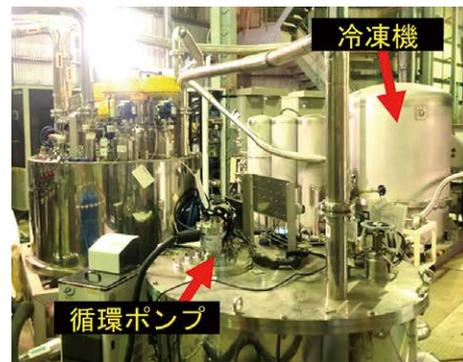
図4-8-2 超電導き電用冷却システム
