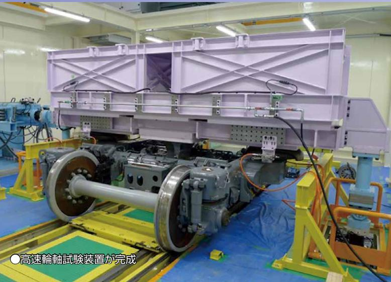
●高速輪軸試験装置が完成
