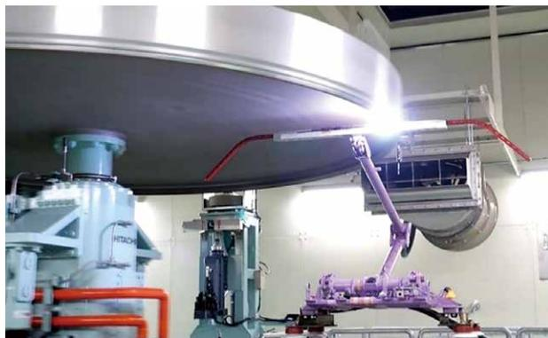
図2-2-1 高速パンタグラフ試験装置
