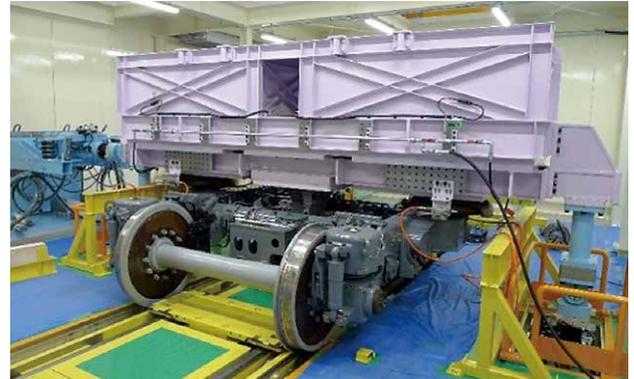
図2-2-3 高速輪軸試験装置
