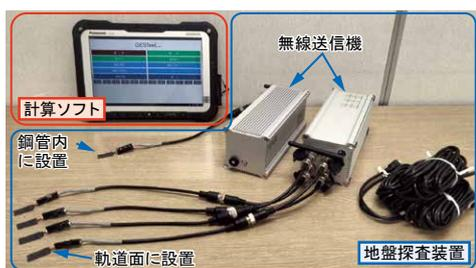
図1 開発した軌道変状推定システム
