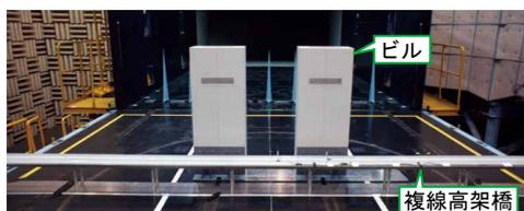
図1 ビル風を模擬した風洞試験
