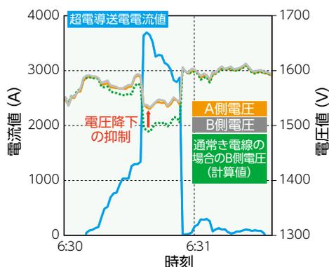
図2 都市圏路線における超電導き電の機能実証
