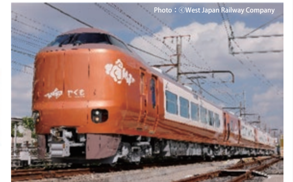
273系やくも (JR 西日本 2024年より運用開始) 次世代振子制御システム導入事例
