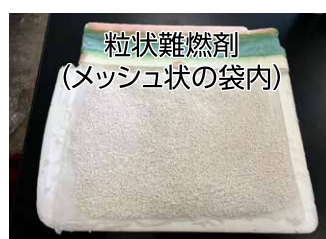
図2 腰掛詰物内の難燃剤
