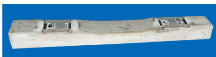
図2 副産物の水酸化アルミニウムを使用したジオポリマーPCまくらぎ（性能試験結果、外観）
