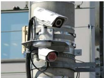
踏切に遠赤外線カメラを設置し、検知性能検証を実施中
