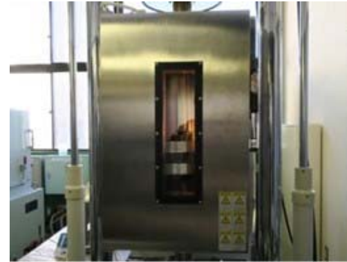
恒温恒湿槽内での弾性係数測定
