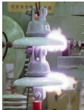
懸垂がいしの雷インパルス試験例
