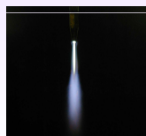
ヘキサンを混合した水素ガス燃焼炎
