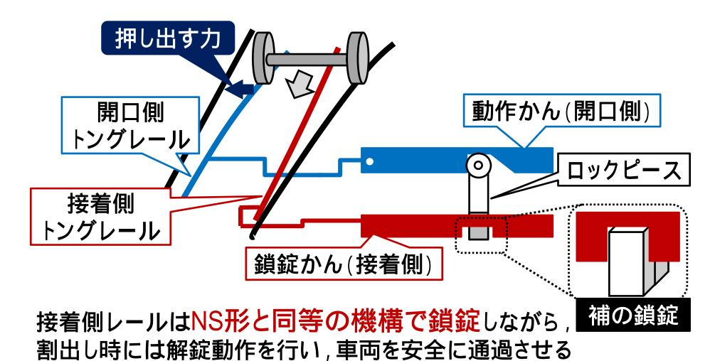
転換制御時の車両通過の保安度向上と,割出し機能を両立
