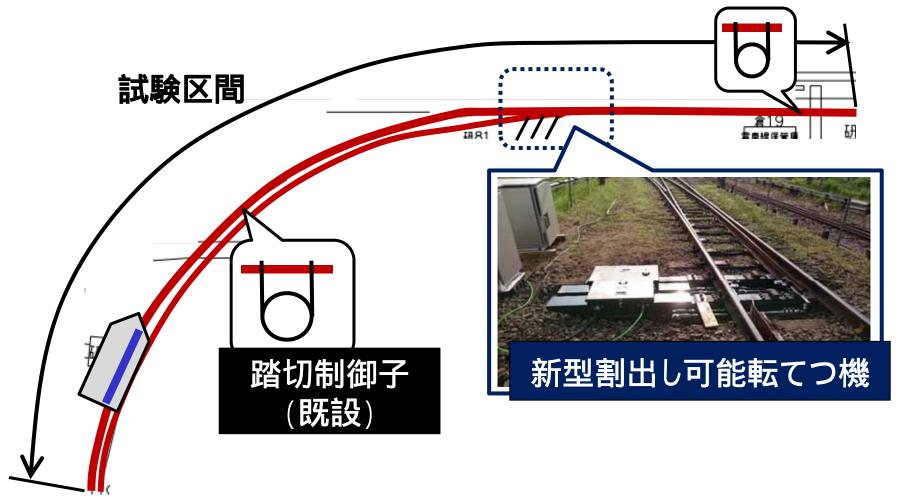
踏切制御子をトリガとして転換制御
