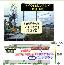
車両周りの高解像度音源分布から沿線騒音を予測する手法です。車両形状等の変更が沿線騒音に及ぼす影響を評価できます。
