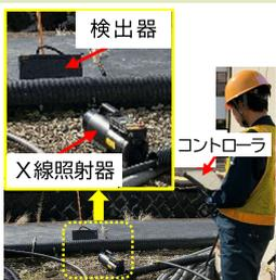
X線を用いて、車両などの設備の内部状態を観察する装置です。対象物の欠陥や劣化を非破壊で高精度に検査できます。
