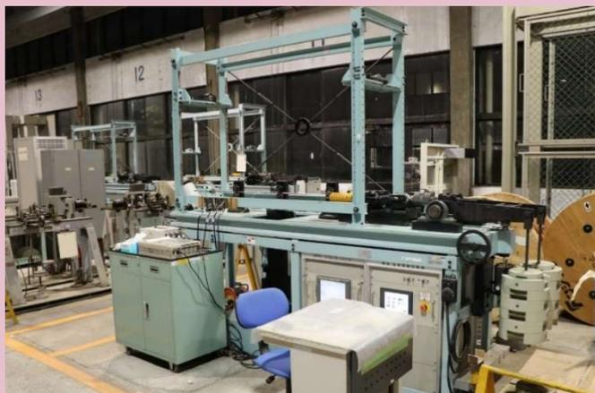
図1 線条・金具振動試験機の外観
