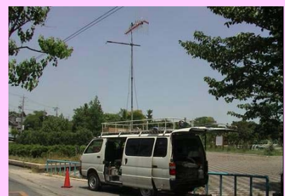
地上デジタル放送の受信品質測定評価試験の様子
