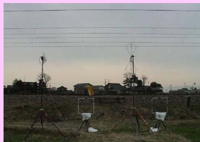
IEC 62236-2準拠の測定試験でのアンテナ設置例
