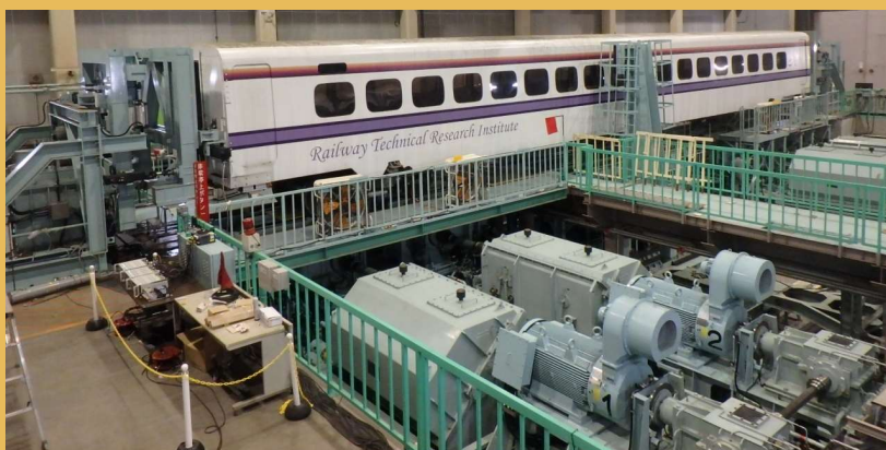
図1 高速車両試験台全景(1車両条件)
