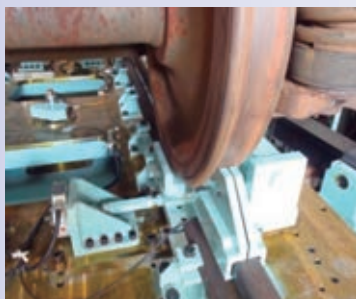
輪重横圧測定ユニット
