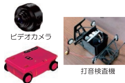
鉄筋探査レーダー ドローンへの搭載装置例
