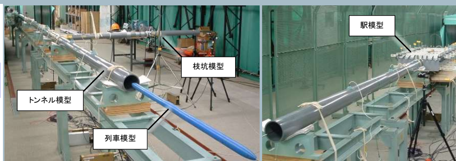
図3 計算精度検証のための模型実験
