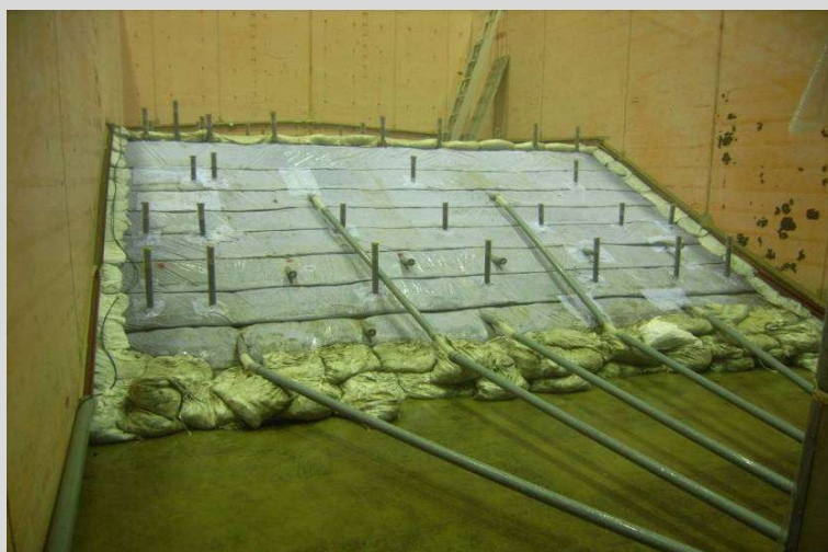
図2 排水工の性能評価試験
