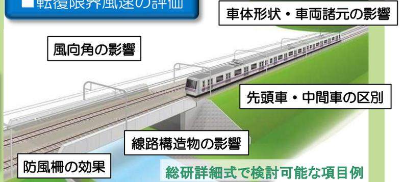
図4 総研詳細式による転覆限界風速の評価
