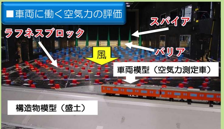
図5 風洞試験による空気力の評価
