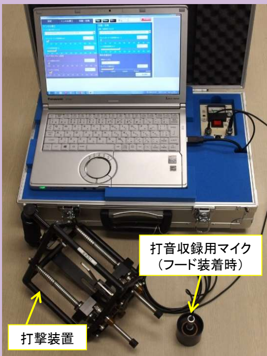
図1 総研式打音検査装置
