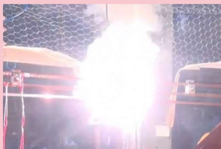
アークの発生(約4mmの間隙)
