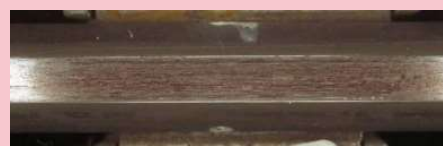
図5 C/C複合材製すり板導入により平滑化したトロリ線しゅう動面
