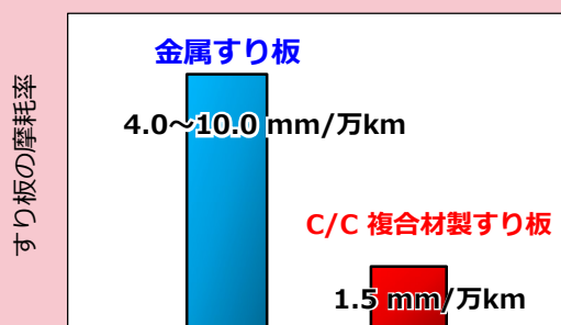
図2 C/C複合材製すり板と金属すり板の摩耗率比較
