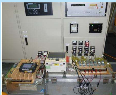
図2 電流測定の様子
