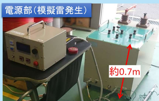
図2 可搬性に配慮した外形
