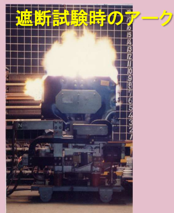
図2 直流高速度遮断器の試験の様子
