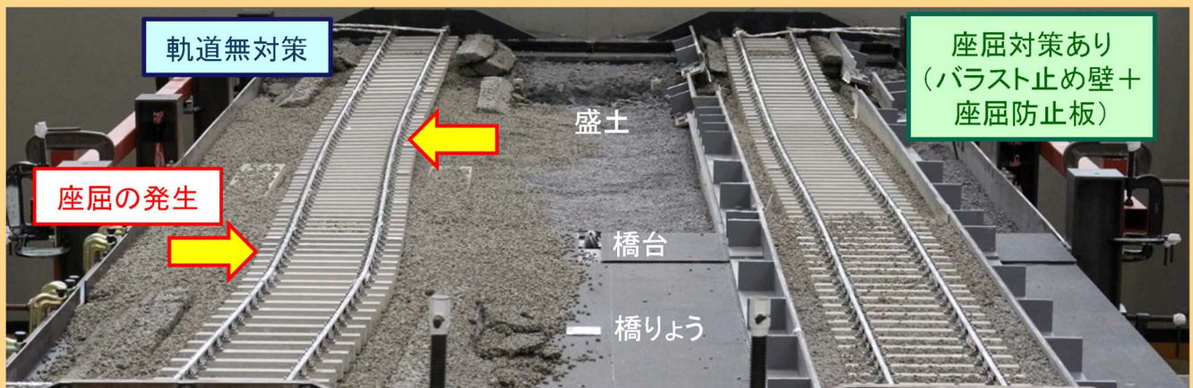
加振後の軌道座屈の状況 (地震時の座屈対策効果の検証)
