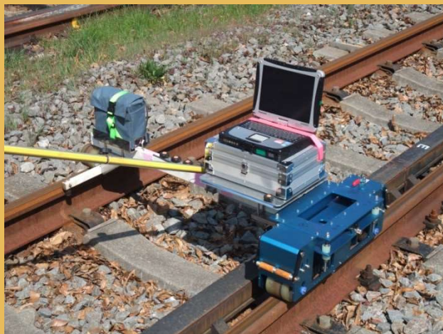
レール凹凸連続測定装置の外観
