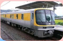
軌道検測車・軌道検測装置
