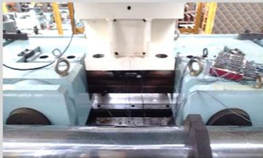
レール曲げ疲労試験の実施状況
