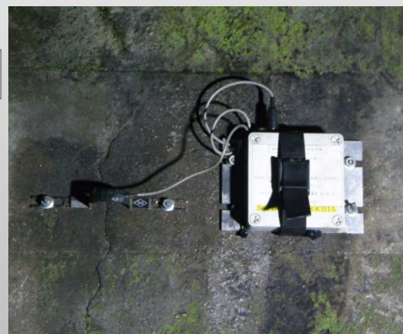
無線センサ子機設置状況
