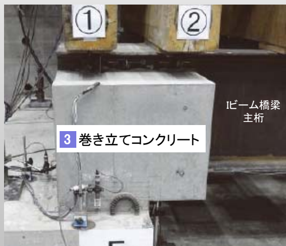
コンクリート巻き立て[検証試験時]
