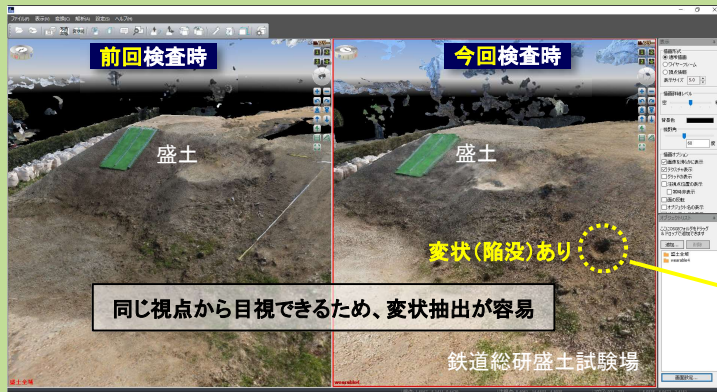
図2 検査時期の異なる3次元画像を直接比較する機能 図3 断面形状取得機能による変状進行性評価
