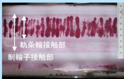
図2 踏面熱き裂(浸透探傷)
