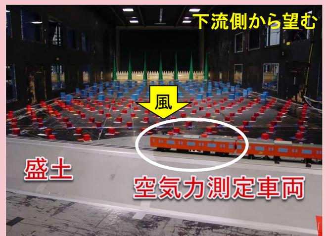
図1 車両形状と線路構造物形状を組み合わせた風洞試験
