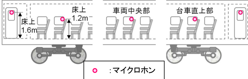
図1 車両の走行試験における車内騒音測定の一例
