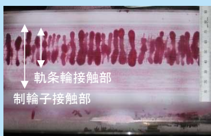
図2 踏面熱き裂(浸透探傷)
