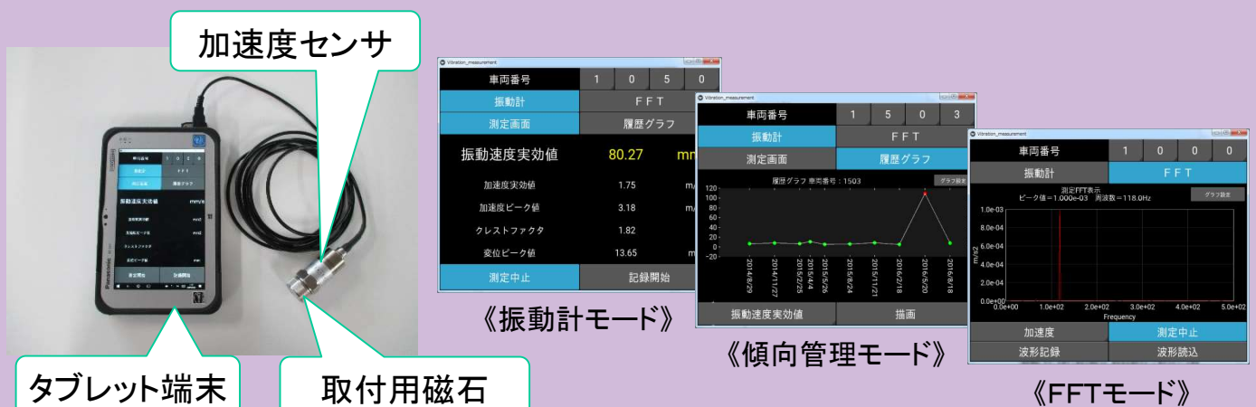
図1 タブレット振動計の外観と測定画面の例
