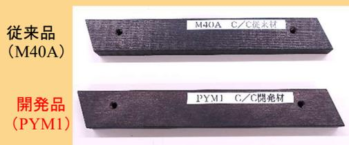
図1 低コスト化C/C複合材製パンタグラフすり板
