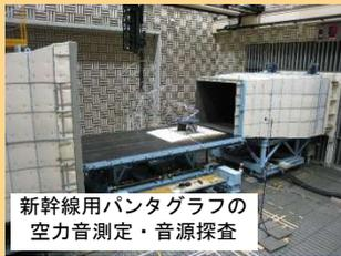
図1 実機パンタグラフの試験例
