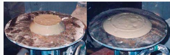
充填材の性状（左：振動前、右：振動後）
