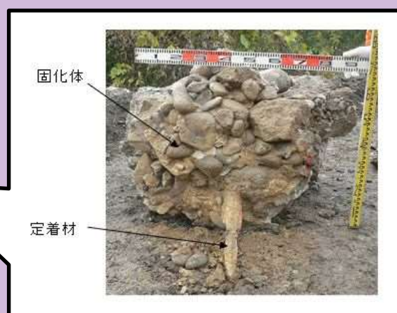
固化体の状況
