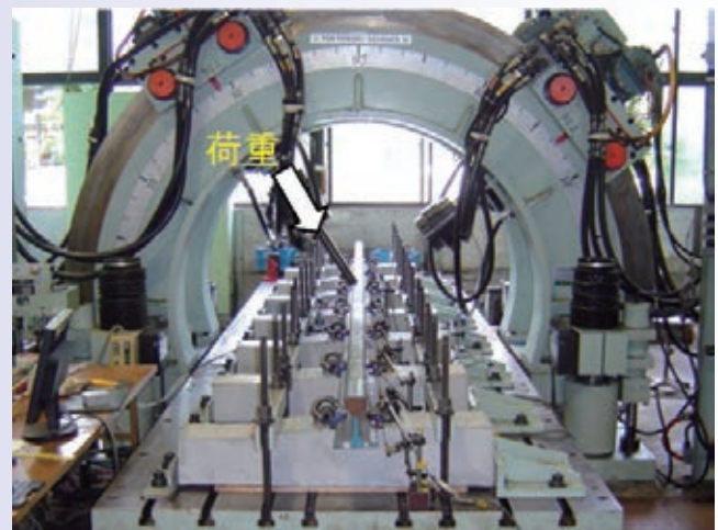
3軸疲労試験機を用いたレール締結装置の疲労試験
