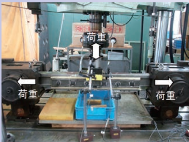
2軸疲労試験機を用いた接着絶縁レールの疲労試験
