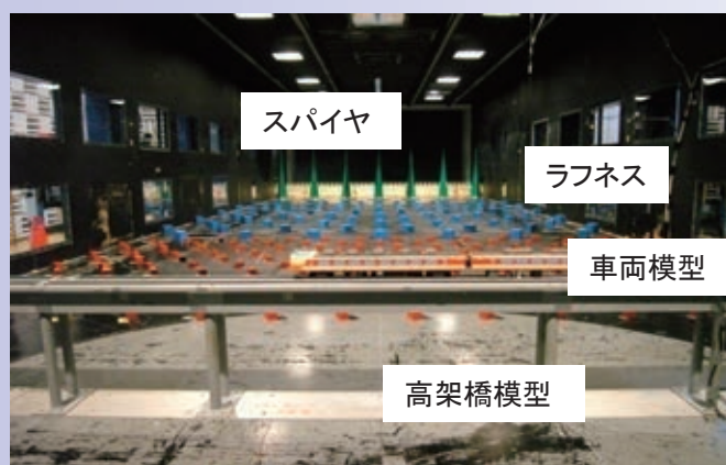
自然風を模擬する装置の設置状況
