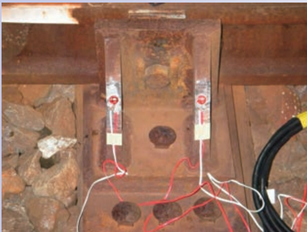
分岐器ガード背面横圧測定
