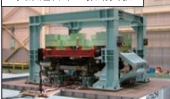
実鉄道台車の振動実験
