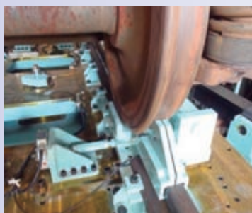
輪重横圧測定ユニット
