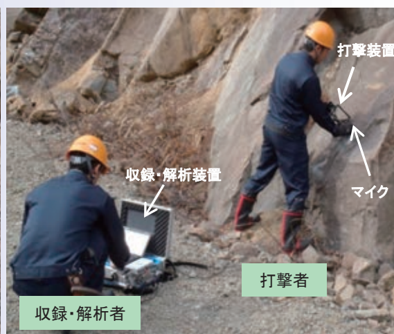
測定状況(基盤岩の例)
